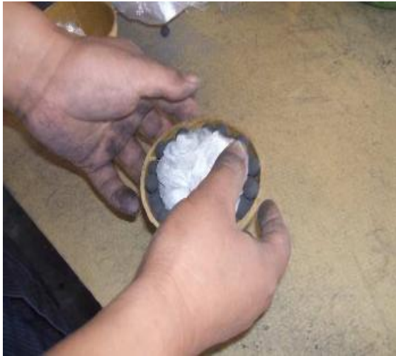
Tillverkning av 4" fyrverkeribomb
