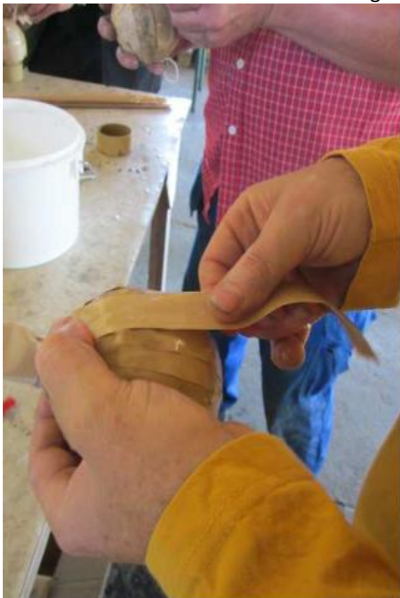
Tillverkning av 4" fyrverkeribomb
